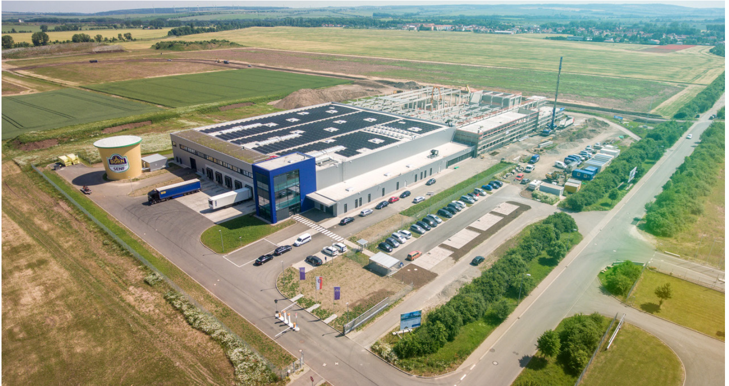
Abb. 9 Luftbild der Born Senf & Feinkost GmbH: Das Dach wird für eine großflächige Photovoltaik genutzt und ist über den Büroräumen begrünt. (Bild: Born Senf & Feinkost GmbH)
