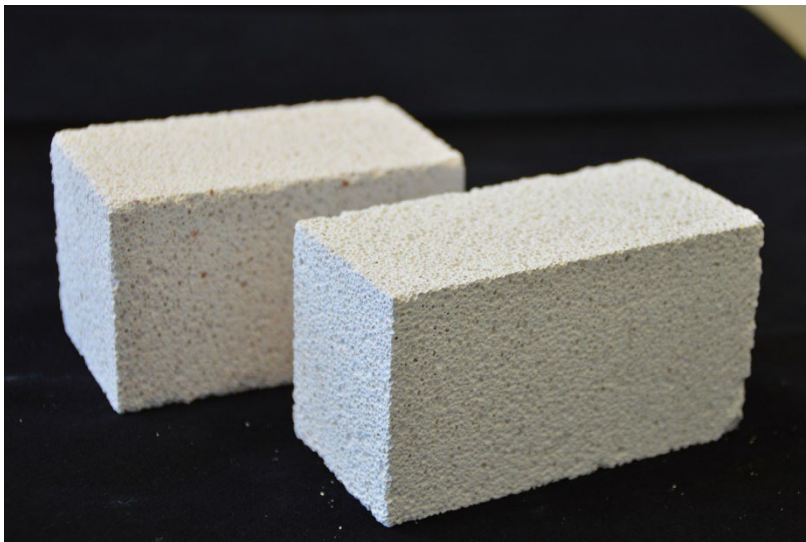
Abbildung 7: Porenbeton aus Ziegel (hinten), Porenbeton aus Kalksandstein (vorne) 204
