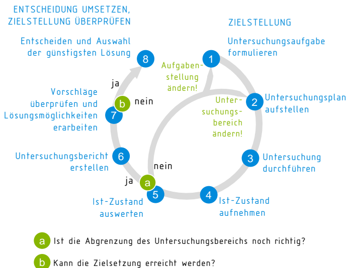
Abbildung 19: Ablaufschema einer Materialflussanalyse 95
