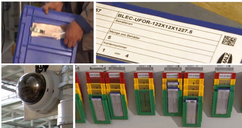
Abbildung 6: Kanban-System für die Teilezulieferung durch die externen Lieferanten der Firma J. Schmalz GmbH 34
