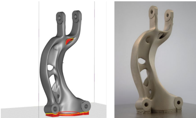
Abbildung 16: Stützstruktur zur Fixierung des Bauteils. Links: Digitales CAM-Modelle Vorbereitung. Rechts: Gefertigtes Bauteil mit Stützstrukturen
