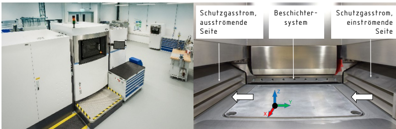
Abbildung 15: Links: Für die Fertigung genutzte EOS M 400/Rechts: M400-Prozesskammer mit zentraler Bauplattform, Beschichtungssystem und Inertgas-Schutzfilm (Stromrichtung: Von rechts nach links)
