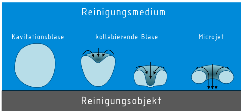
Abbildung 2: Schematische Darstellung einer kollabierenden Kavitationsblase 15
