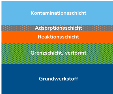
Abbildung 4: Schichtartiger Aufbau kontaminierter metallischer Bauteiloberflächen 16
