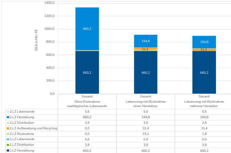
Abbildung 9: Kumulierter Energieaufwand (KEA) der Szenarien ohne und mit Rücknahme in MJ je funktioneller Einheit
