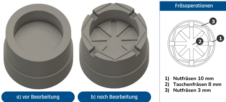
Abbildung 7: Referenzbauteil vor und nach Bearbeitung mit zugehörigen Fräsoperationen 93
