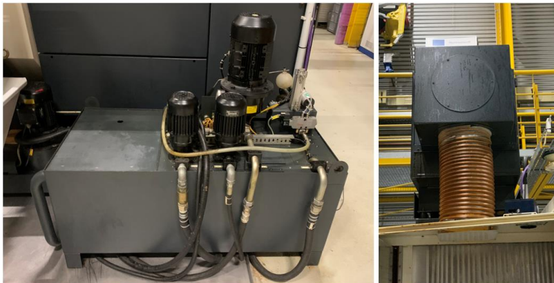
Abbildung 6: Links: KSS-Anlage mit 250-Liter-Tank, Förderpumpen und integriertem Filterkorb; rechts: Öl-/Emulsionsnebelabscheidung oberhalb des Maschinenraums © TU Braunschweig, IWF (Hans Engel) 86
