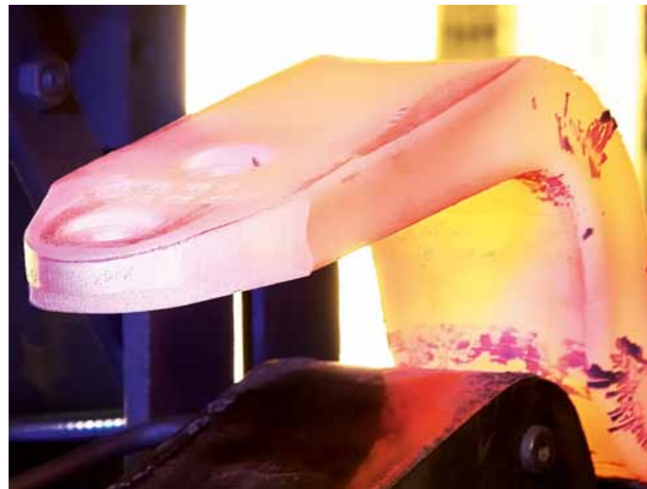
Patentiertes und energieeffizientes Produktionsverfahren zur Herstellung von Nutzfahrzeugfedern (EnRed)
