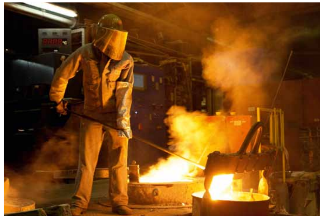
Abschlacken einer Edelstahlschmelze bei einer Temperatur von 1600 Grad Celsius
